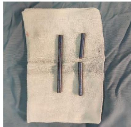
(Gambar 2. Rod sisi patah pada sisi kanan)
